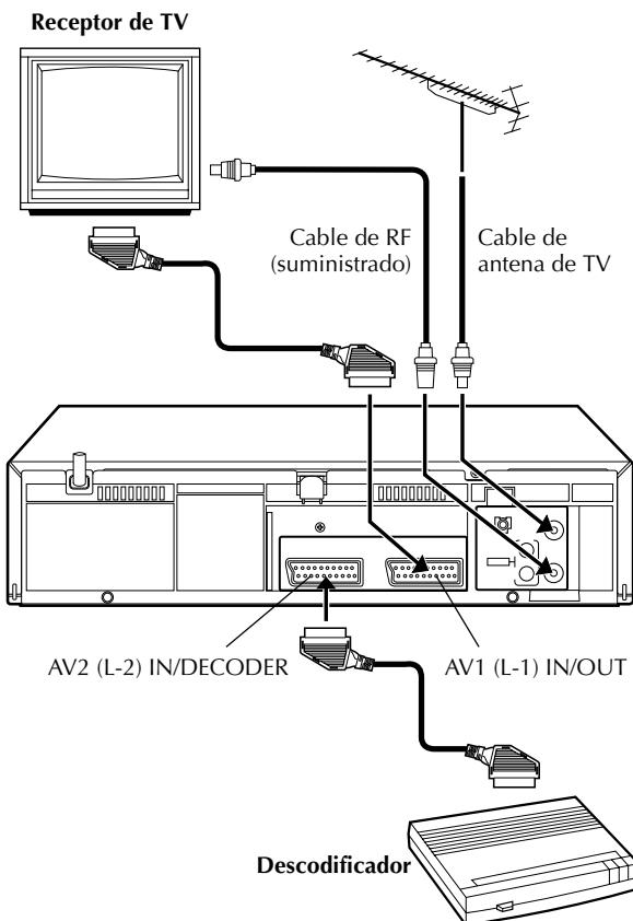
El conector AV2 (L-2) IN/DECODER puede ser utilizado como conector de entrada para un descodificador externo (descodificador). Simplemente conectando un descodificador podrá disfrutar de una variedad de programas disponibles a través de los canales codificados.
