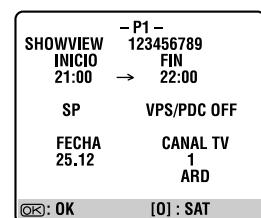
El panel de indicación frontal muestra el tiempo de inicio del programa. El presionar **?** cambia la indicación al tiempo de fin de programa, luego a la fecha y finalmente a la posición del canal.
